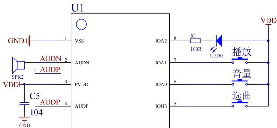
备注：电源两端务必加104P电容，距离VDD保持在10MM以内为佳。
